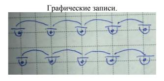
Рис.10. Схема переплетения - перекрестное переплетение на базе ластика со сдвигом на 1 t иг. (волан)
